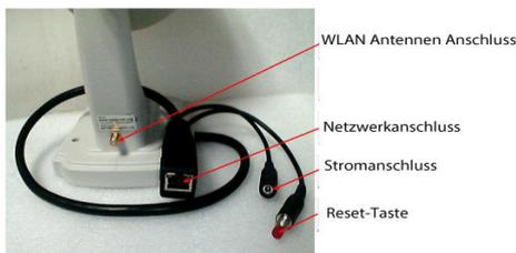
Verbinden Sie die Kamera zum Einschalten mit dem Stromnetz und per Netzwerkkabel mit dem Router, um sie ins Netzwerk einzubinden. Eine Verbindung per WLAN muss zuvor per Kabel konfiguriert werden.
